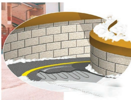
Cavi scaldanti per uso civile
